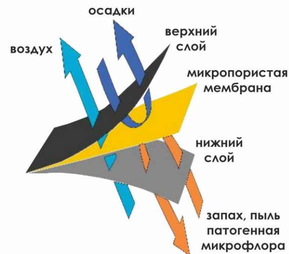
Структура мембраны «КомпостМат»
